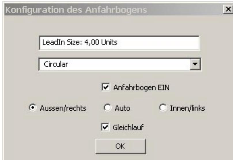
**Abb. 2.11: Einstellungen der Fräser Radiuskorrektur für Layer INNEN-2**
