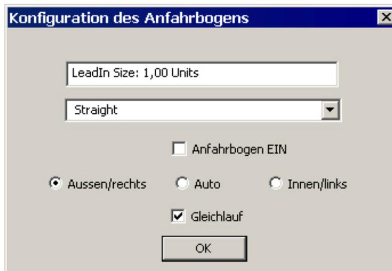
Abb. 1.53: Dialogbox für Fräser Radiuskorrektur
