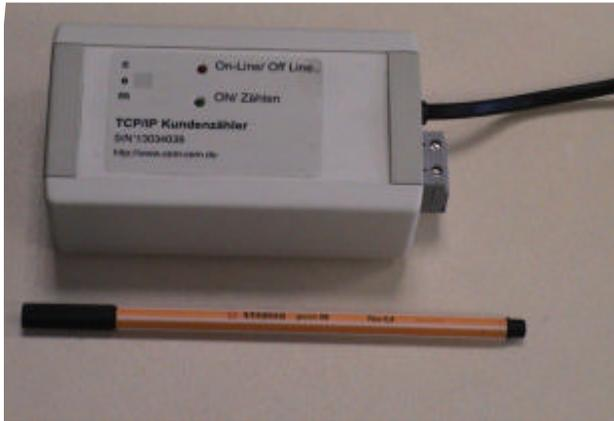
Einfaches System aus zwei aus zwei Einheiten bestehend: Einer Erfassungseinheit ( z.B. einer Lichtschranke ) und einem Datenspeicher die TCP/IP fähig ist.
