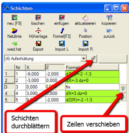
Die **Höhe** der Profilpunkte, sowie die Entfernung **links** bzw. **rechts** der Achse kann mit den entsprechenden Werten X und Z befüllt werden oder es kann auch mit **Formeln** gearbeitet werden. Wenn die Schicht mit der Achse verknüpft ist, dann ist für den **verknüpften Ausgangspunkt** als Formel **FIX** einzugeben. Dieser Punkt muss aber nicht bei X=0 und Z=0 liegen, sondern kann auch über oder unter oder neben der Achse liegen.
