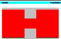
Se requiere energía para incrementar la velocidad del flujo del aceite en una restricción. Esta energía se toma de la presión. Si el vacío que se produce es inferior a -0,3 bar, se precipita el aire disuelto en el aceite. Cuando la presión sube de nuevo debido a la disminución de la velocidad, el aceite estalla dentro de las burbujas de gas.
