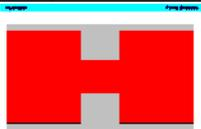
En puntos de fuerte restricción pueden producirse caídas de presión hasta el vacío, causando la precipitación del aire disuelto en el aceite. Cuando la presión sube de nuevo, el aceite estalla en las burbujas de gas y puede producirse una ignición espontánea de la mezcla aceite/aire.
