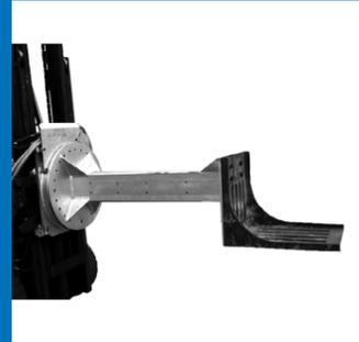
Chargiergerät – teleskop und drehbar für Gießereieinsatz
