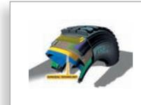
Goodyear-Reifen mit DuraSeal Technologie besitzen in der Lauffläche eine zusätzliche Lage. Diese besteht aus einer speziellen gelben, gelartigen Gummimischung. Wenn der Reifen von einem Gegenstand, wie zum Beispiel einem Nagel, verletzt wird, fließt das Gel in das Einstichloch.
