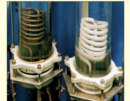
Praxisnaher Test - so ermittelt der DVGW (ebenso Stiftung Warentest bereits im Jahr 2000) die Wirksamkeit alternativer Kalkschutzverfahren: Rechts hat sich bereits nach drei Wochen Testdauer eine beeindruckende Menge Kalk abgelagert. Der linke „Boiler“ (mit entsprechendem Kalkschutzgerät betrieben) ist sauber, kann hygienischer und mit wesentlich weniger Energieaufwand arbeiten.
