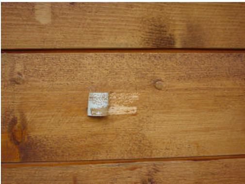
*Prüfung der Tragfähigkeit mittels Klebeband*
