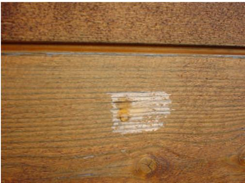
Benetzungsprobe mit Wasser
