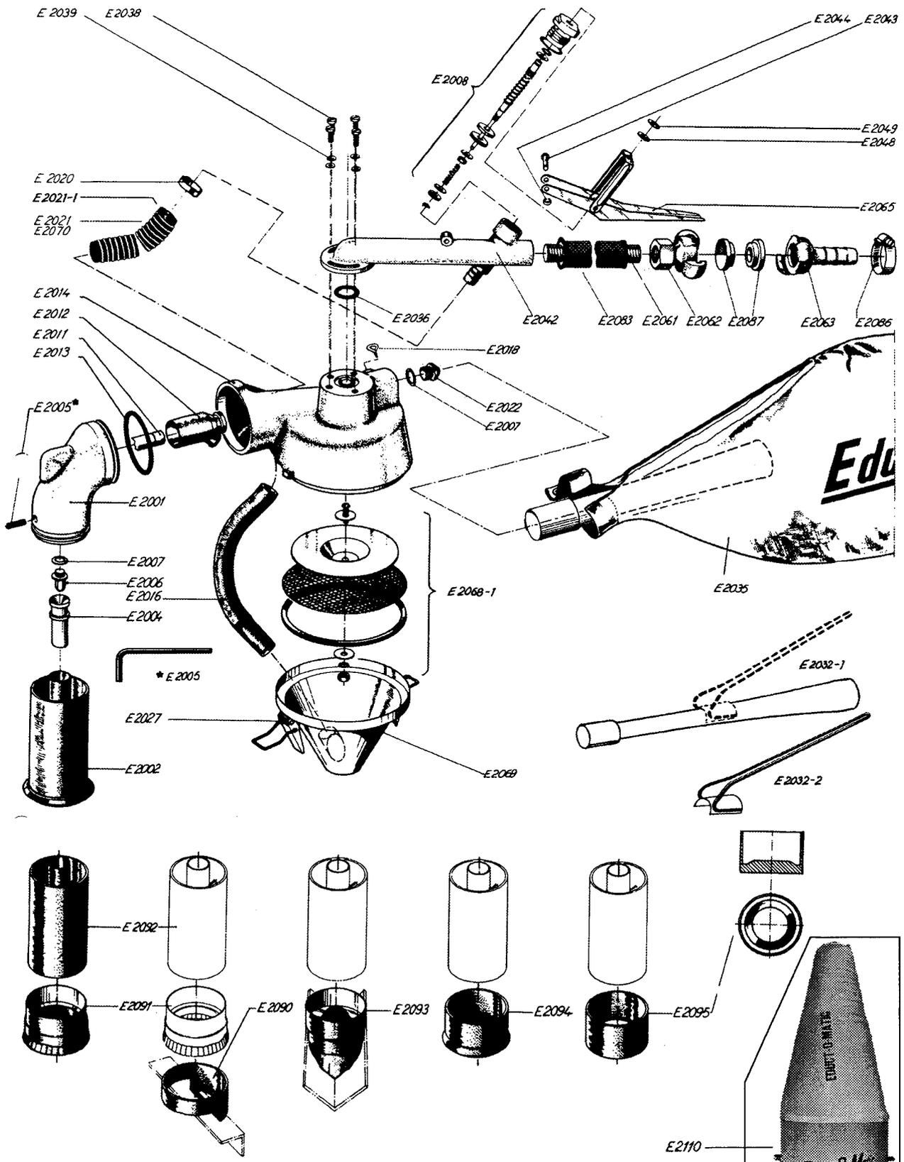
**Ersatzteilliste Handstrahlgerät EDUCT-O-MATIC**
