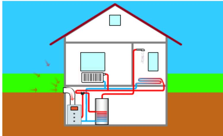
Die Luft/Wasser-Wärmepumpe nutzt die von der Sonne erwärmte Außenluft. Da bei niedrigen Lufttemperaturen die Heizleistung sinkt, der Wärmebedarf aber steigt, sollte ein zweiter Wärmeerzeuger die Luft/Wasser-Wärmepumpe ergänzen. In Gebäuden mit sehr niedrigem Wärmebedarf, z.B. in Niedrigenergiehäusern, ist die Luft/Wasser-Wärmepumpe bei monoenergetischer Auslegung ganzjährig in der Lage die gesamte Wärmeerzeugung zu leisten.
