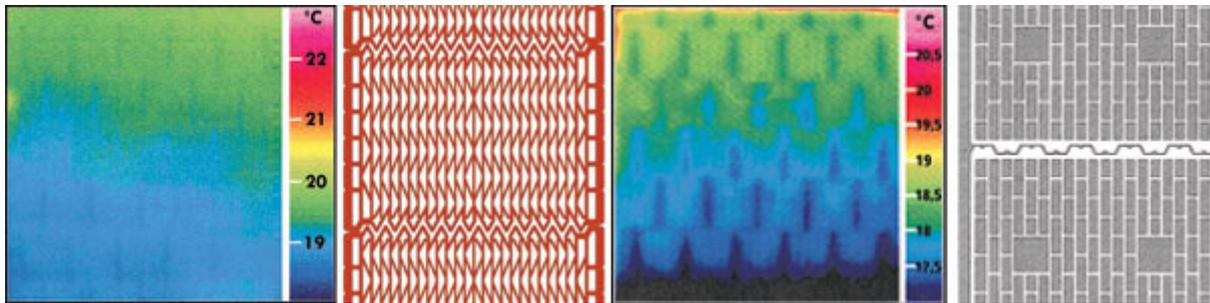
Diese Abbildungen zeigen die Auswirkung der Stoßfuge auf den Wärmedurchgang in einer Ziegelwand:
