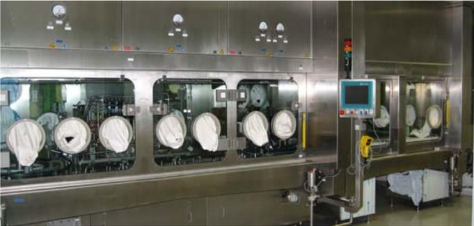
Toxische Produkte, welche aseptisch abgefüllt werden müssen, stellen sehr hohe Anforderungen an den Isolator. Themen wie Luftführung, Zonenkonzepte, Filtersysteme und Reinigung müssen alle in einem Projekt zusammengefasst werden. Anhand eines realisierten Projektes wird aufgezeigt, wie die "Gratwanderung" zwischen GMP und daraus folgendem Produkteschutz, sowie Personensicherheit gelöst werden kann.
