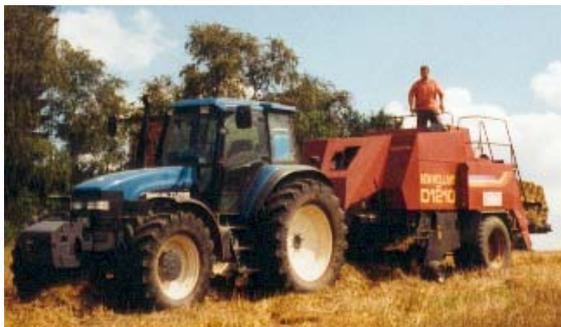
Diese abgebildete Strohballenpresse, verarbeitet das Stroh auf die Maße 90/125/250 (H/B/L in cm). Durch eine Vorkammerpresstechnik wird das Stroh erst gesammelt und unter großem Druck verdichtet. In der zweiten Kammer wird das Material dann gebunden. Im Gegensatz zu herkömmlichen Bau-
