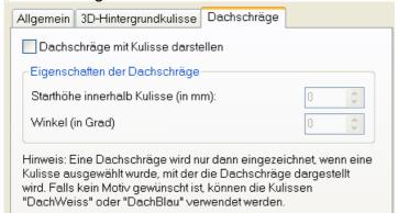
Eine Dachschräge wird mit der oder den ausgewählten Kulissen dargestellt. Dazu muss die Option *Dachschräge mit Kulisse darstellen* aktiviert sein. Die Werte für die Dachschräge können dann wie gewünscht eingegeben werden.
