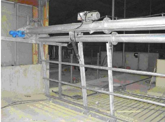
Der Kuhstreiber dient zum Vortreiben im Vorwartehof. Er wird elektrisch angetrieben. Das Absperrgitter lässt sich hydraulisch hochschwenken.
